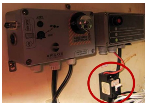
Figure 32 – Boîtier de raccordement d'un VMS équipé d'un interrupteur marche/arrêt
