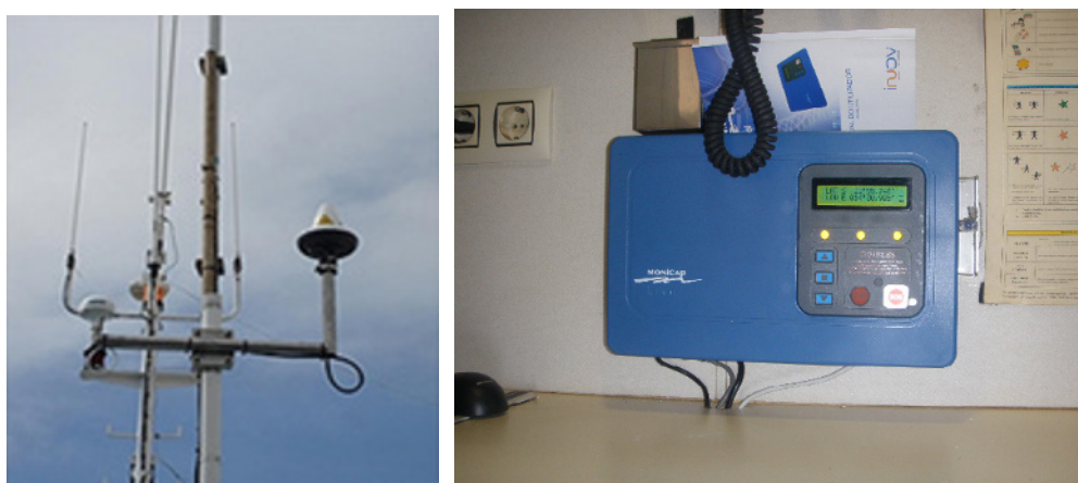
Figure 30 – Exemples d'antenne VMS (à gauche) et d'émetteur-récepteur (à droite)
