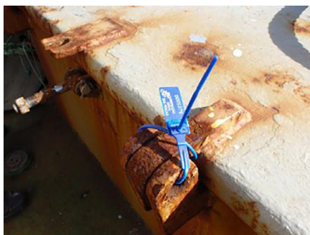
Figure 89 – Exemple de scellement de l'accès à la soute
